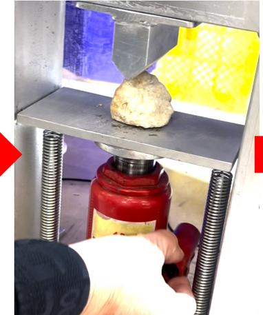
↑歯の部分にジオードの先端をセットし、カバーをかけます。
